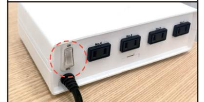
15A 以上の電流が流れると物理ブレーカーが作動します。
